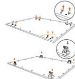
Рисунок 5.3. Схема врізного монтажу.
