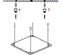
Рисунок 5.4. Схема підвісного монтажу.
